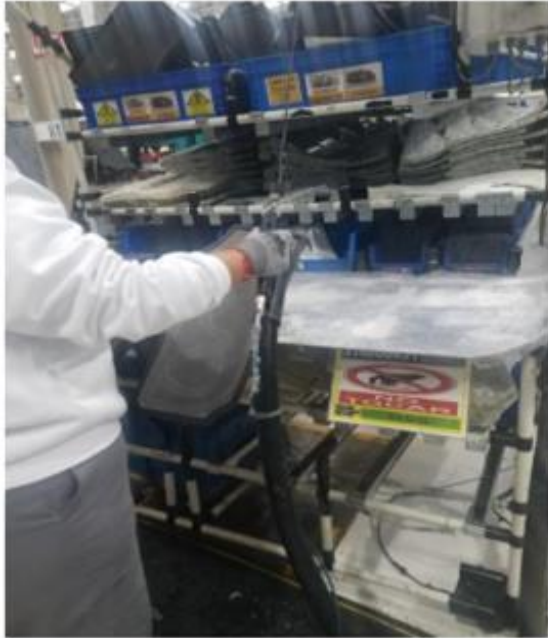
Figura 4.1 Proceso de la aplicación de adhesivo modo manual
